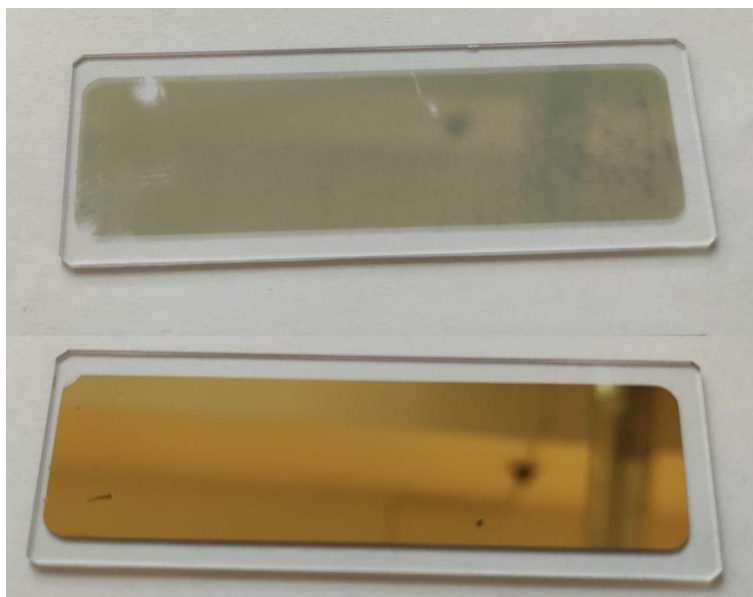
Obr. 15: Napařené vzorky ze zlata
