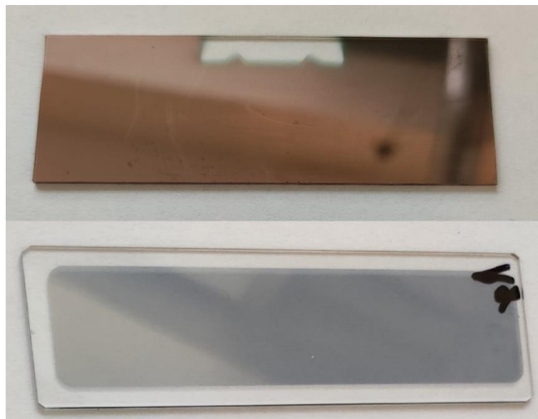
Obr. 14: Napařené vzorky z mědi a stříbra
