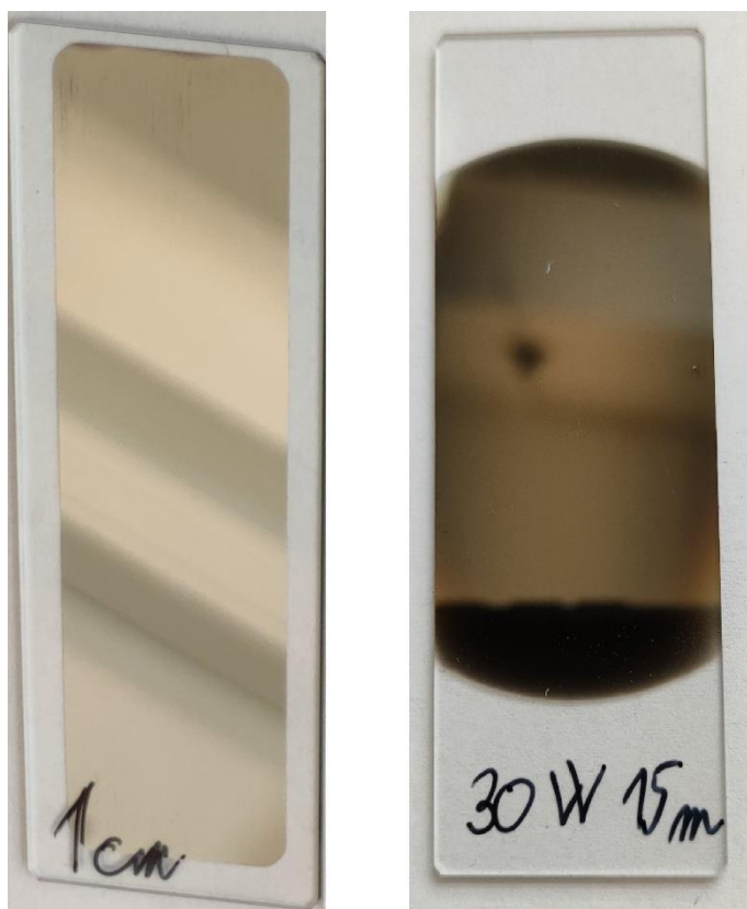
Obr. 6: Vlevo napařená vrstva, vpravo naprášená vrstva
